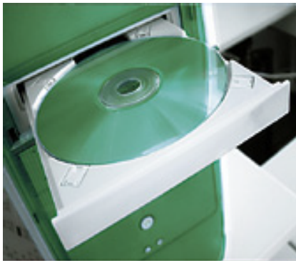
Рис. 2.4. Оптический диск в устройстве для его считывания/записи
