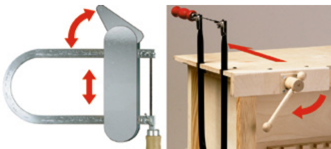
Рис. 56. Приспособление для стягивания рамки лобзика
