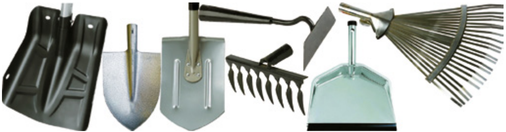
Рис. 167. Изделия, детали которых изготовлены холодным штампованием
