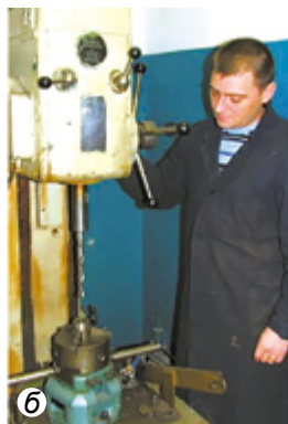
Рис. 165. Изготовление деталей резанием: а – на токарных станках; б – на сверлильных станках; в – на распиловочных станках
