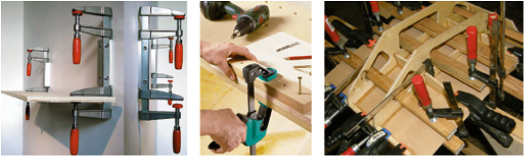
Рис. 106. Уплотнение склеенных деталей струбцинами
