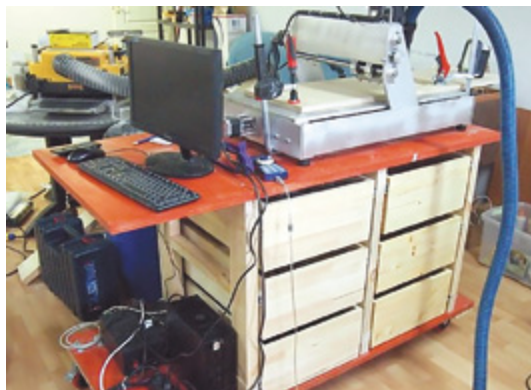
Рис. 153. Настольный лазерный аппарат
