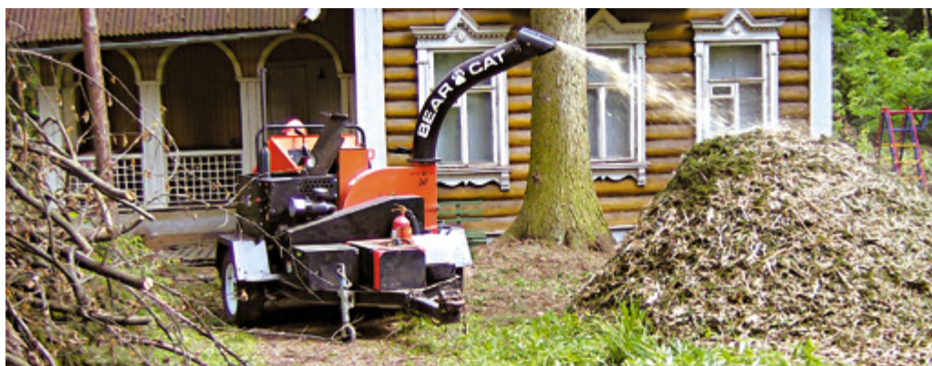
Рис. 32. Измельчение отходов древесины
