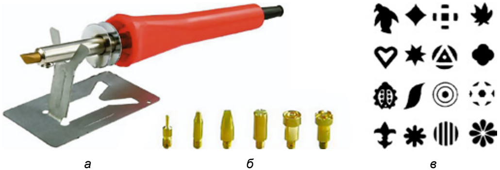
Рис. 141. Стержневой выжигатель: а – общий вид; б – стержневые штампы; в – элементы выжженных орнаментов
