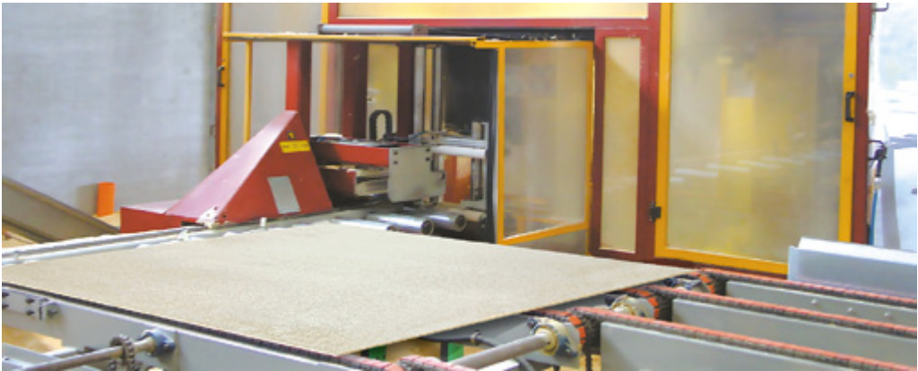
Рис. 33. Производство древесноволокнистых плит
