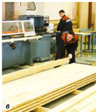
Рис. 165. Изготовление деталей резанием: а – на токарных станках; б – на сверлильных станках; в – на распиловочных станках
