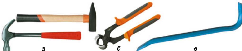
Рис. 110. Основные инструменты для соединения деталей с помощью гвоздей: а – молотки; б – клещи; в – инструмент для вытягивания гвоздей
