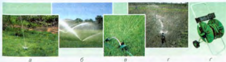
Мал. 176. Дощувальні установки: а – вібраційна; б – циркуляційна; в – струменева; г – пульсуюча; г' – дощувально-фільтраційний шланг
