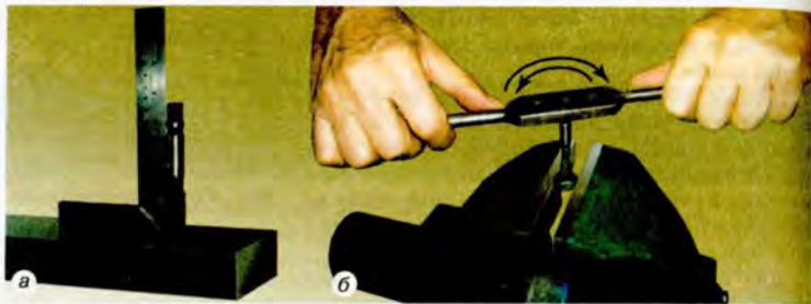
Мал. 101. Нарізування внутрішньої різьби: а – установлення мітчика; б – прийоми нарізання різьби
