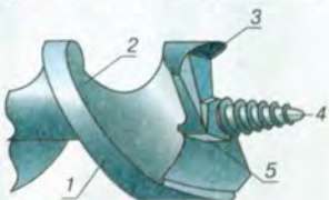
Мал. 132. Шнекове свердло: 1 – шнек; 2 – канавка; 3 – бур; 4 – вістря; 5 – різальні кромки
