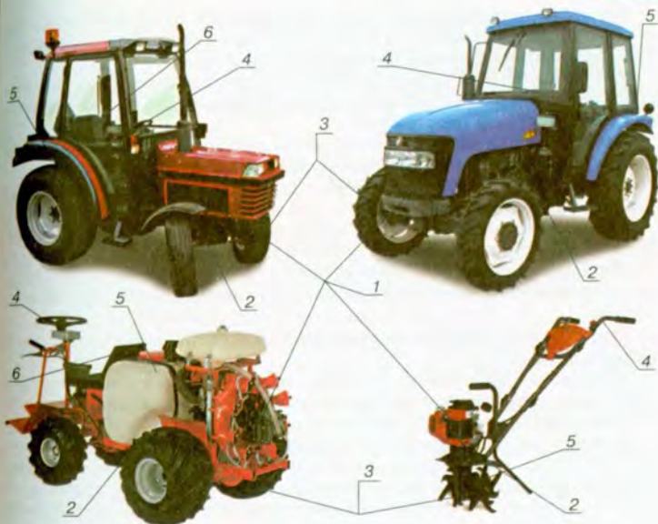
Мал. 209. Основні вузли малогабаритної техніки: 1 – двигун; 2 – трансмісія; 3 – ходова частина; 4 – механізми керування; 5 – робоче обладнання; 6 – допоміжне обладнання
