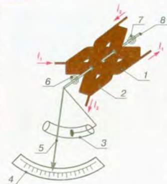
Мал. 149. Схема приладу електродинамічної системи: 1, 2 – котушки; 3 – заспокоювач; 4 – шкала; 5 – стрілка; 6, 7 – пружини; 8 – вісь
