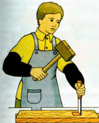
Мал. 118. Прийом роботи долотом
