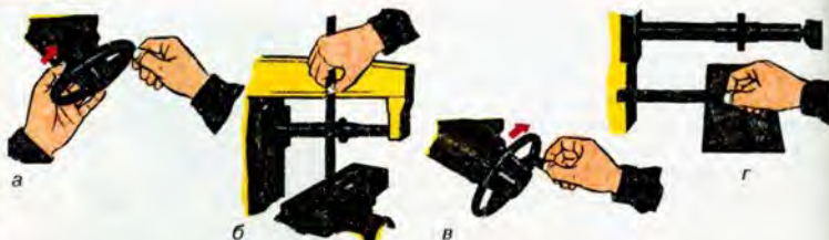
Мал. 73. Установлення величини переміщення стола горизонтально-фрезерного верстата НГФ-110 Ш4 по лімбу: а – установка нульової поділки лімба; б – вимірювання відстані від стола до хобота верстата; в – вертикальне переміщення стола; г – вимірювання відстані від стола до корпусу
