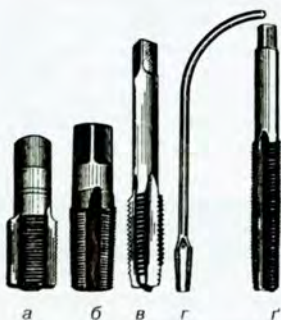
Мал. 102. Види мітчиків: а – циліндричний; б – конічний; в – гайковий; г – із відігнутих хвостовиком; г – плашковий
