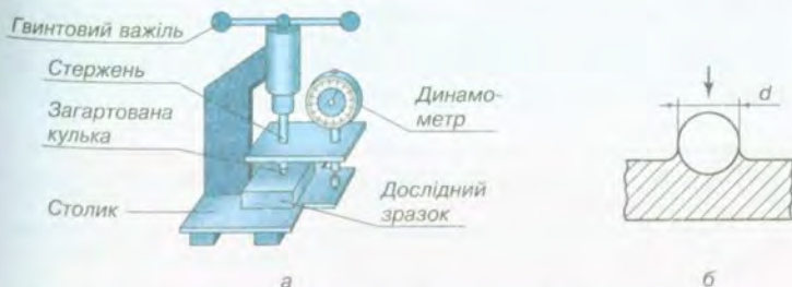
Мал. 58. Визначення твердості за методом Роквелла: а – прилад Роквелла; б – схема заглиблення кульки
