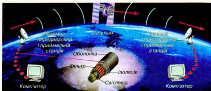
Мал. 14. Схема прийому-передачі інформації за допомогою телекомунікаційних технологій
