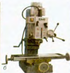
Мал. 60. Класифікація фрезерних верстатів: а – горизонтально-фрезерний консольний; б – вертикально-фрезерний безконсольний; в – карусельний
