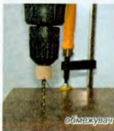
Мал. 135. Свердління отвору з обмежувачем
