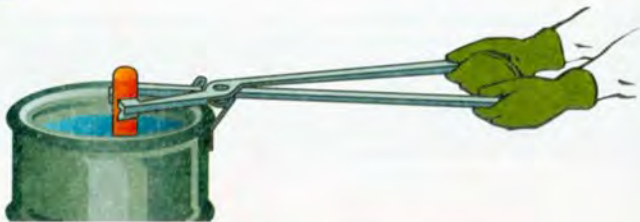
Мал. 111. Прийом охолодження деталі в рідині
