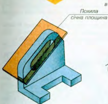
Мал. 40. Прості розрізи: а – фронтальний; б – профільний; в – горизонтальний; г – похилий
