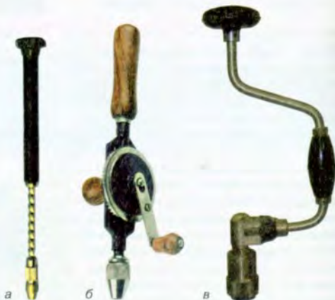
Мал. 137. Ручні свердлильні інструменти: а – бур із насадкою; б – ручний дріль; в – коловорот
