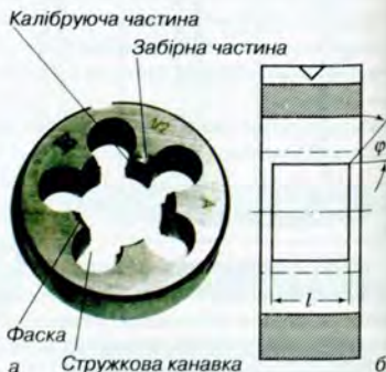
Мал. 103. Плашка суцільна: а – загальний вигляд; б – геометричні параметри плашки
