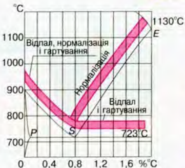
Мал. 109. Діаграма термічної обробки сталі
