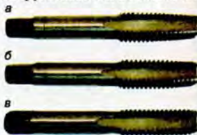
Мал. 99. Комплект мітчиків: а – чорновий; б – середній; в – чистовий
