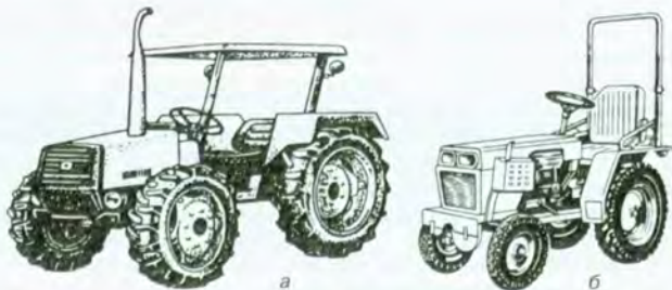
Мал. 210. Малогабаритні трактори Харківського тракторного заводу: а – малогабаритний тепличний трактор марки Т-30 АТ; б – малогабаритний трактор марки Т-08
