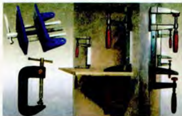
Мал. 122. Струбцини для кріплення деталей при довбанні та для ущільнення деталей при склеюванні
