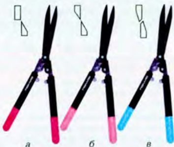
Мал. 182. Газонно-бордюрні ножиці: а – з одним загостреним лезом; б – з односторонньо загостреними лезами; в – з двосторонньо загостреними лезами
