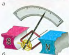
Мал. 145. Амперметр: а – зовнішній вигляд; б – схема принципу дії
